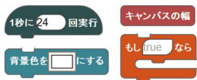
図 2 ブロックの形状の種類。左上からスタート、コマンド、右上からアウトプット、ルールブロック。
